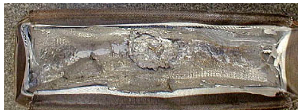
Bolsa combinado superior estándar con óxidos retenidos. Abajo, bolsa combinada Pyrotek TF con óxidos retenidos.
