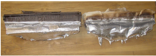
Deformación del distribuidor y óxidos retenidos: bolsa combinada TF versus bolsa combinada estándar
