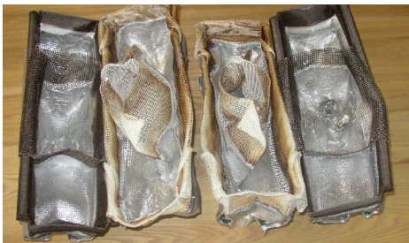
Deformación del distribuidor y óxidos retenidos: bolsa combinada TF versus bolsa combinada estándar
