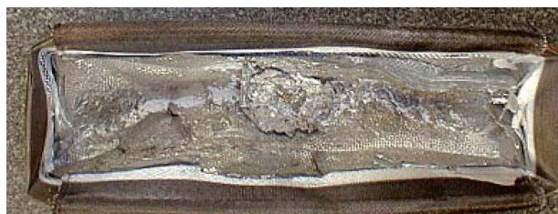
上图, 标准缝制分流袋和氧化皮。 下图, Pyrotek TF 分流袋和氧化皮。
